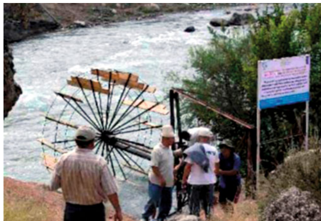
Рис. 2. Береговое (консольное) размещение свободнопоточной турбины — водяного колеса
