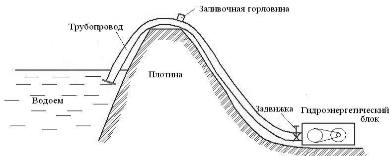
Рисунок 5 – Схема установки мобильной приплотинной гидроэлектростанции сифонного типа
