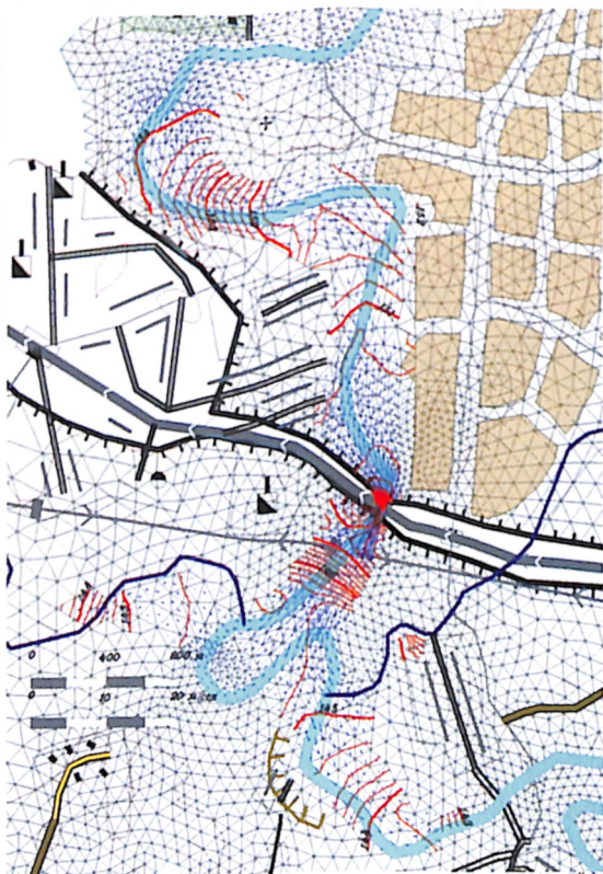
Векторное поле скоростей течения и горизонтали водной поверхности в районе мостового перехода через 2 ч после начала паводка.
