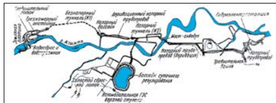
Схема сооружений Краснополянской ГЭС
