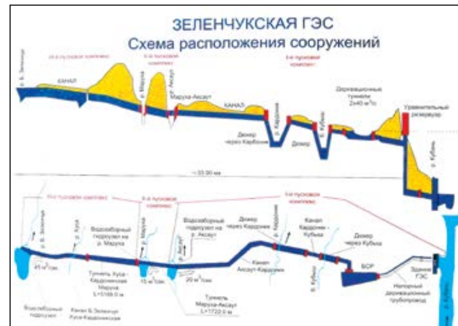
Схема сооружений Зеленчукской ГЭС
