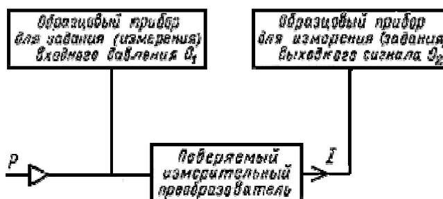
б) установкой по образцовому прибору  $O_2$  расчетного значения выходного сигнала, соответствующего заданному номинальному значению измеряемого давления, и измерения по другому образцовому прибору  $O_1$  действительного значения измеряемого давления.
