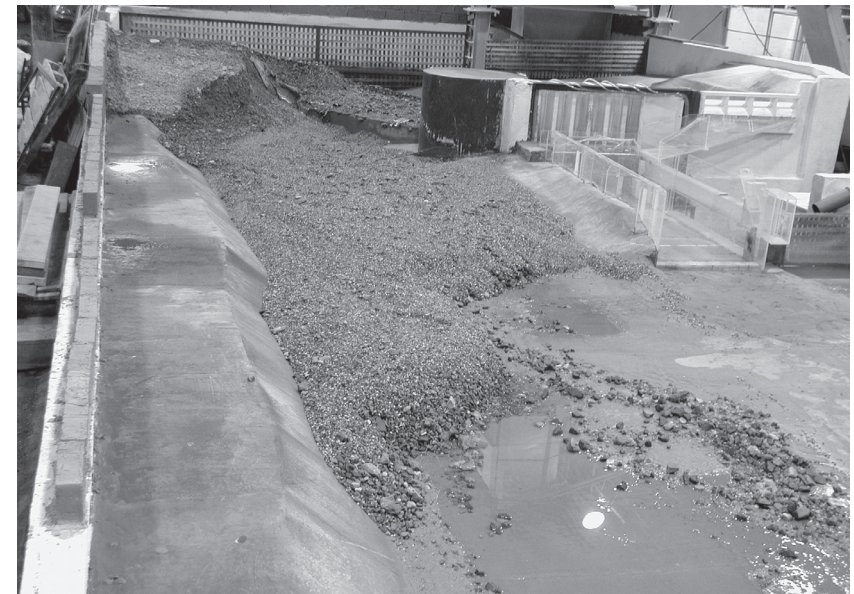
Рис. 10. Вид экспериментальной установки после окончания размыва плотины
