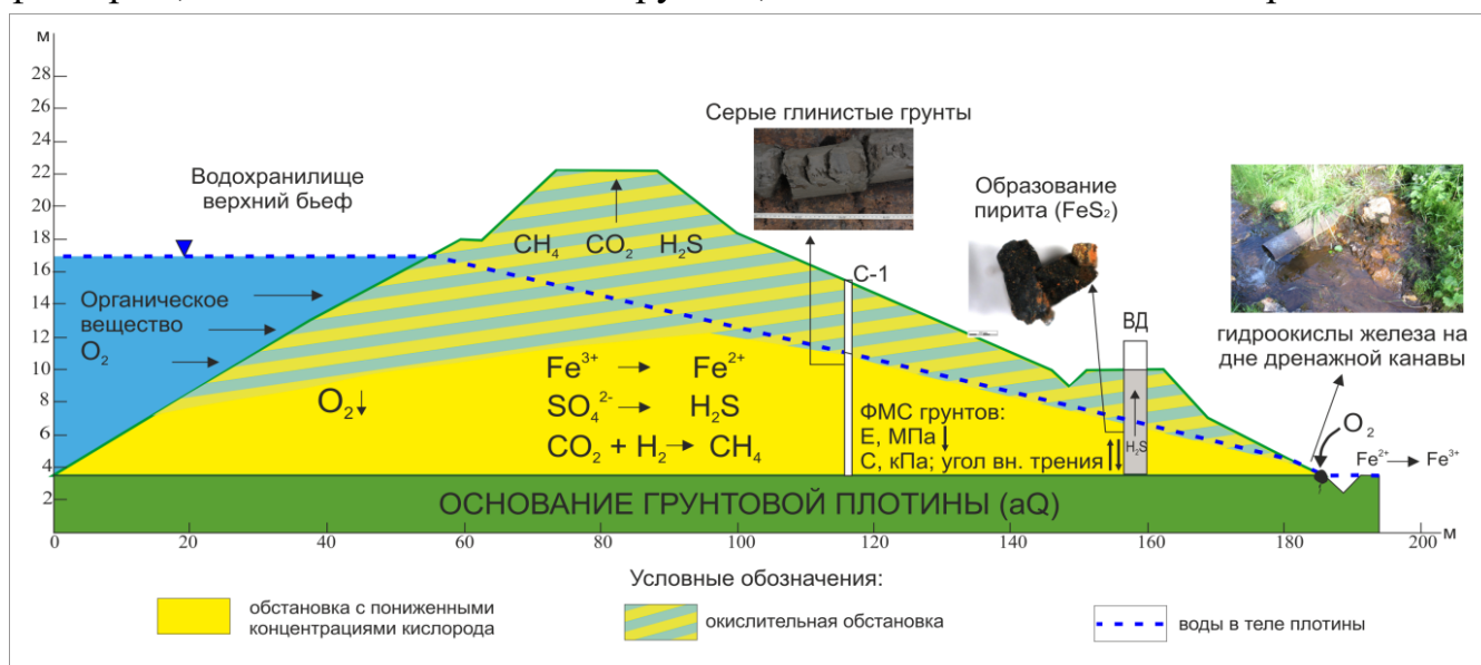
Рисунок 9. Ориентировочная схема последствий развития микробиологических процессов в грунтовой плотине (ВД - колодец вертикального дренажа; С-1 - скважина; ↑ - увеличение; ↓ - уменьшение)
