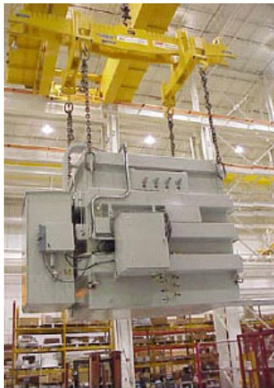
**Трехфазный ВТСП-трансформатор мощностью 5-10 МВА**
