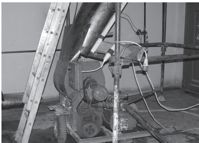
Рис. 4. Поршневой насос «СО-180» для подачи бетонной смеси к месту укладки
