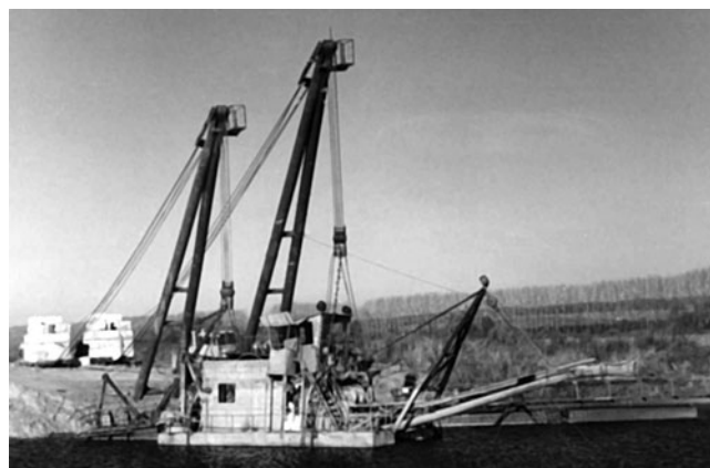
Рис. 5. Земснаряд с грунтовым насосом 10ГрУЛ-8, поднятый из р. Пахры в 1994 г.
