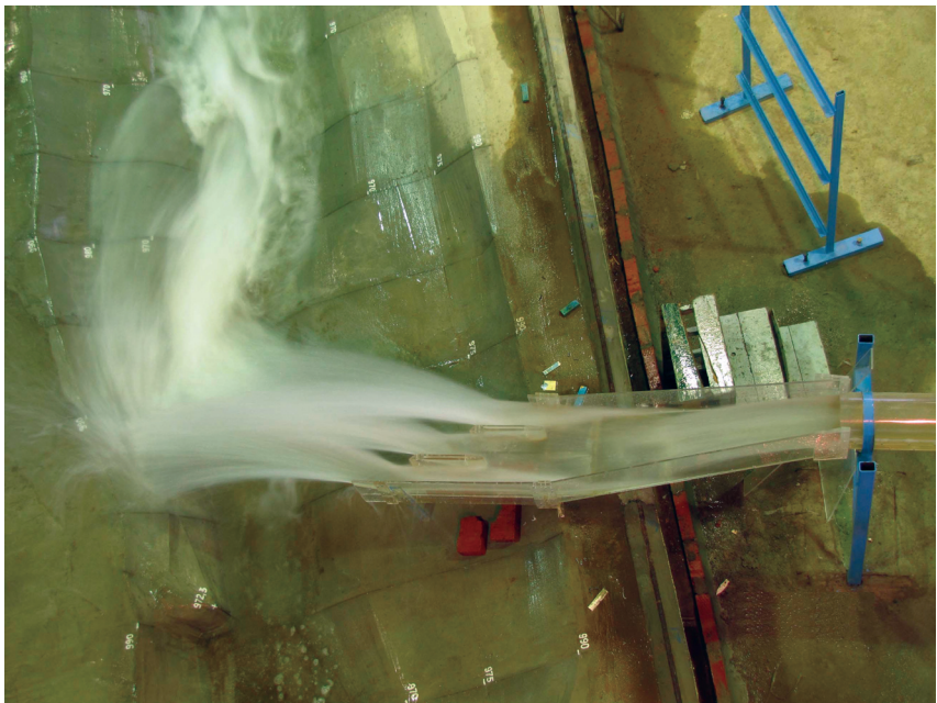
Рис. 5 Режим работы конечного сооружения (вариант с осевым потоком на отводящем безнапорном участке, конечное сооружение прямое) при пропуске расхода Q = 3\,500\text{ м}^3/\text{с}
