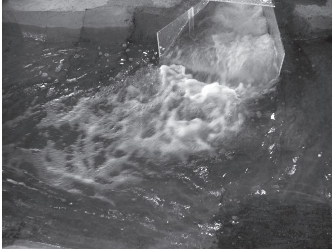
Рис. 16. Режим течения в реке Вахш при сбросе в нее расчетного расхода Q_{III} = 3\,500 \text{ м}^3/\text{с} из туннеля СТ-3: ( УВБ = 1\,185 \text{ м} ; Q_{ГЭС} = 1\,500 \text{ м}^3/\text{с} ; УНБ = 977,8 \text{ м} )
