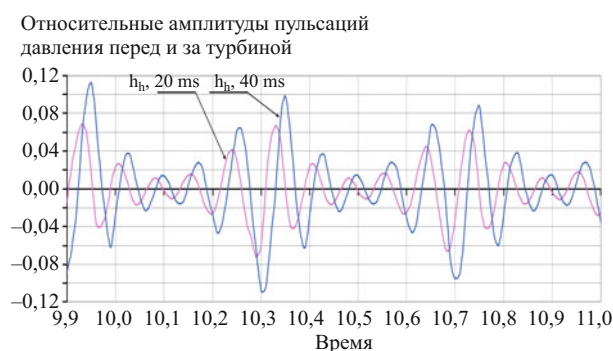
Рис. 18. Оциллограмма пульсаций давления перед турбиной при частоте следования импульсов возмущения 0,5 Гц: длительность импульса возмущения 0,02 с — малиновый цвет, 0,04 с — синий цвет
