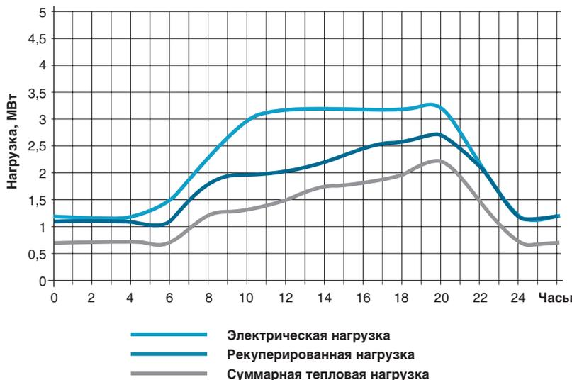
**График электрической и тепловой нагрузки**
