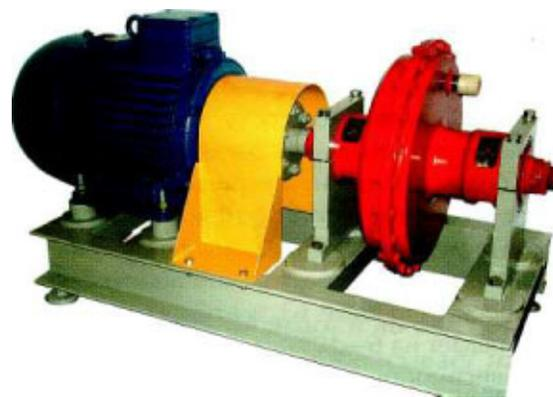
**Рис. 2. Тепловой гидродинамический насос ТС1-011**
