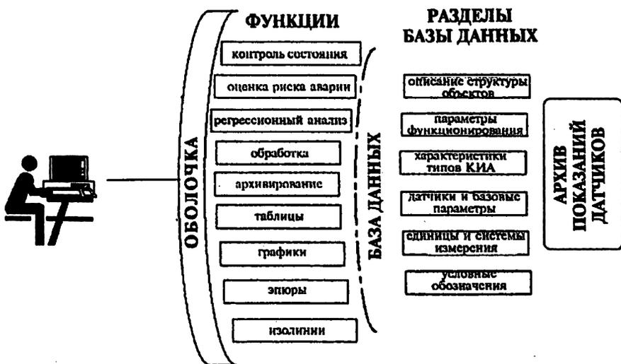
Рис.3. Структура программного обеспечения информационно-диагностической системы.
