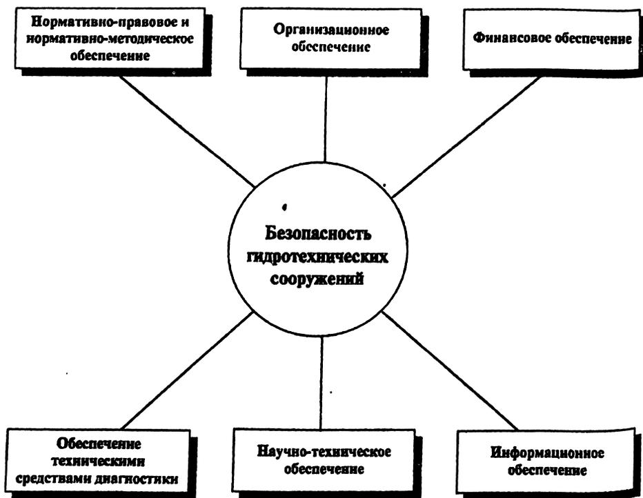
**Рис. 1.** Основные направления обеспечения безопасности гидротехнических сооружений
