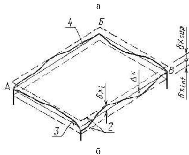
а - допуск плоскостности и отклонение от плоскостности при измерениях от прилегающей плоскости; б - то же, при измерениях от условной плоскости, проходящей через три крайние точки реальной поверхности;
