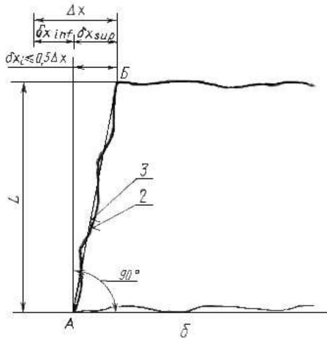
а - допуск и отклонения при измерениях на заданной длине;
