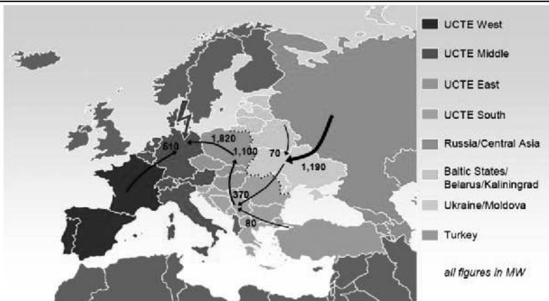
Рис. 7. Регулируемый переток после аварийного отключения 3000 МВт в UCTE
