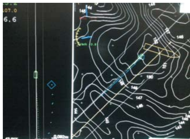
Фото 1. Навигационный планшет для пилота ТПА
