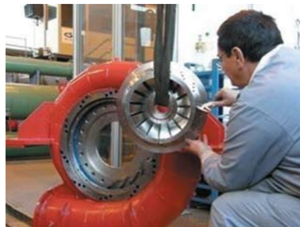
Фото 6. Замер геометрии модели во время проведения модельных испытаний турбины
