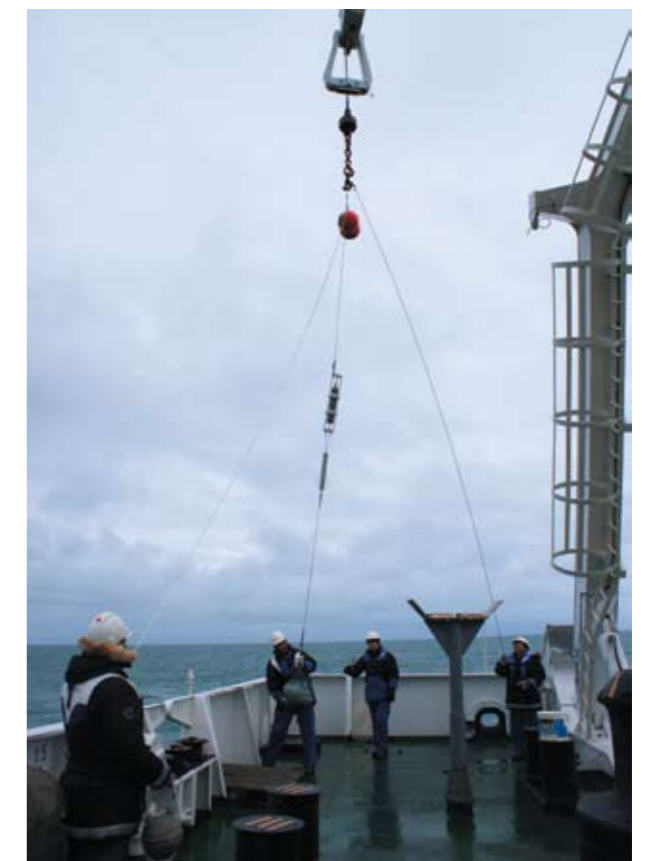
Фото 4. Подготовка конструкции Tide Gauge к спуску
