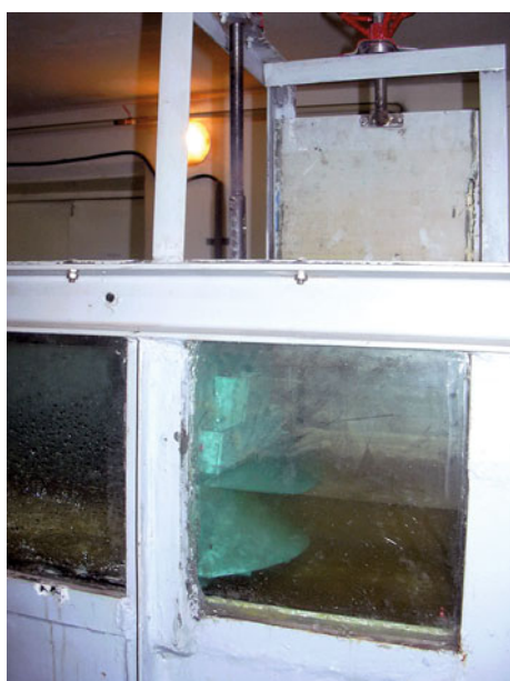
Рис. 5. Гидравлические исследования модели СРВКК (момент начала перелива в нижнюю секцию короба)
