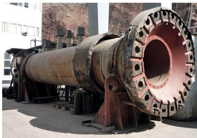
Рис. 1. Вал гидротурбины Рогунской ГЭС на площадке хранения
