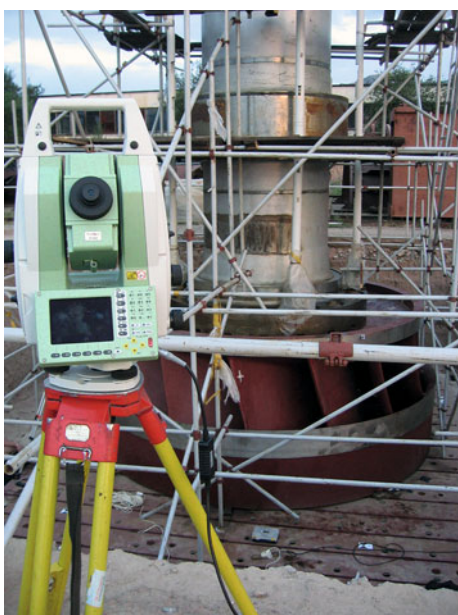
Рис. 7. Обмер сборки рабочего колеса — вала гидротурбины прецизионным тахеометром “Leica TDRA6000”
