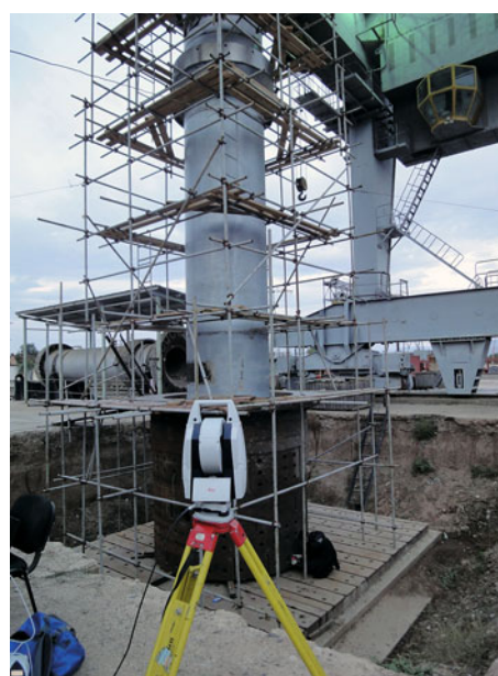
Рис. 8. Обмер контрольной сборки вала гидротурбины — втулки ротора с применением абсолютного лазерного трекера “Leica AT401”
