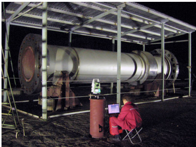
Рис. 5. Определение неперпендикулярности фланца оси горизонтально расположенного вала
