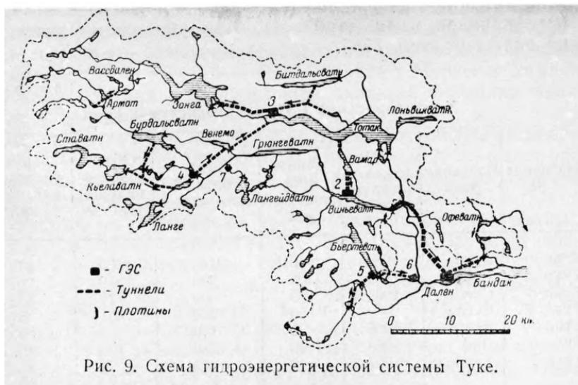
Рис. 9. Схема гидроэнергетической системы Туке.
