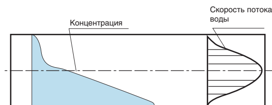
Рис. 4. Концентрация частиц в обратной сетевой воде
