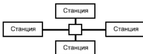
Рисунок 3 - Топология "звезда"
