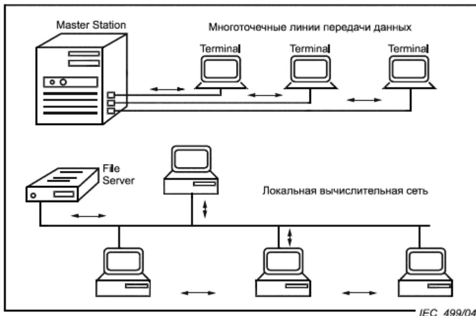
Рисунок 2 - Различия между многоточечными линиями передачи данных и локальной вычислительной сетью
