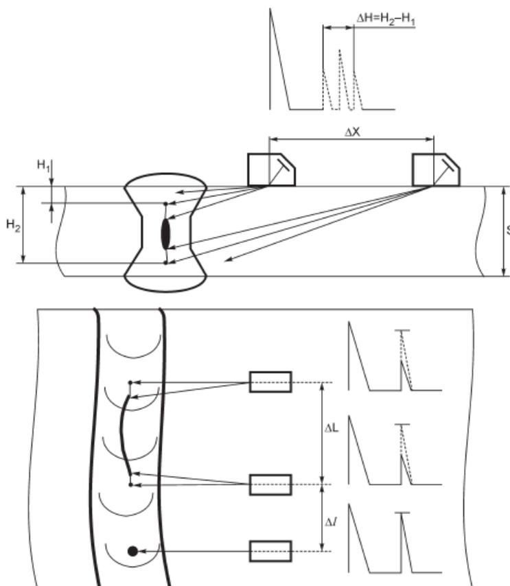
Рисунок 23 - Измерение условных размеров дефектов
