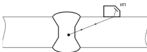
Рисунок 1 - Эхо-импульсный
