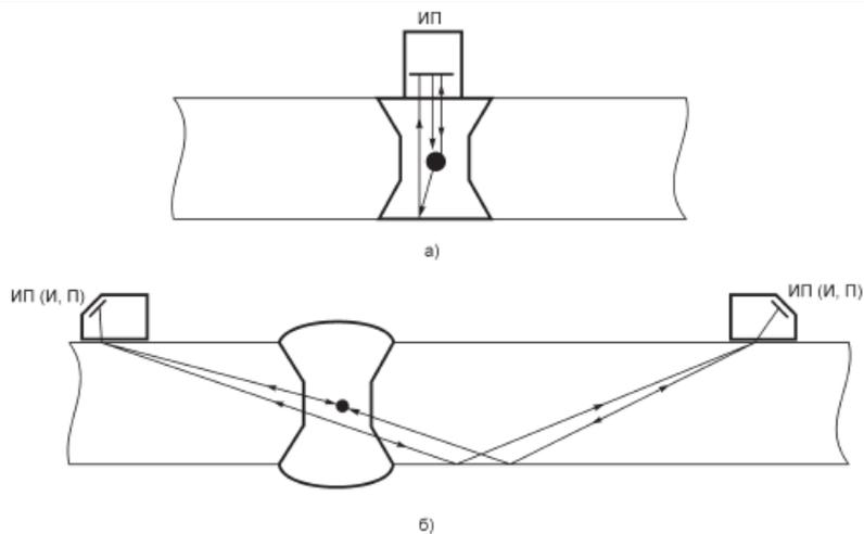
Рисунок 3 - Эхо-теньевой прямым (а) и наклонными (б) ПЭП
