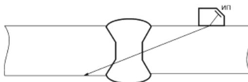
Рисунок 7 - Схема прозвучивания стыкового сварного соединения прямым лучом
