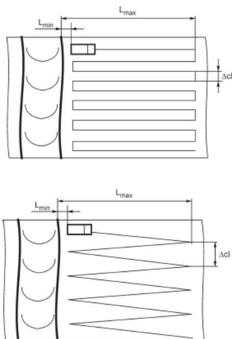
Рисунок 19 - Варианты способа поперечно-продольного сканирования
