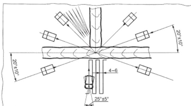
Рисунок 18 - Схемы прозвучивания мест пересечений стыковых сварных соединений
