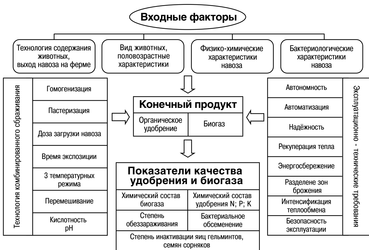
Рис. 2. Блок - схема входных факторов, технологии комбинированного сбраживания и эксплуатационно-технических требований к биоэнергетической установке, обеспечивающих качество конечного продукта
