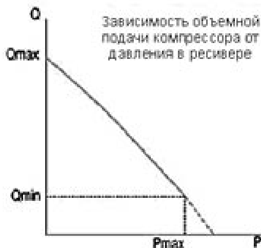
Зависимость объемной подачи компрессора от давления в ресивере
