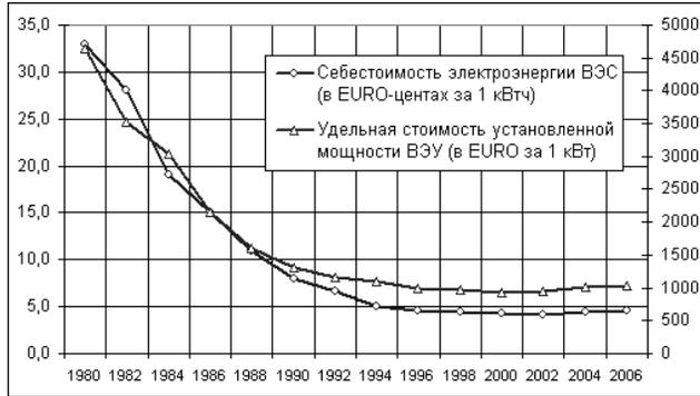
**Рис. 2.** Динамика удельной стоимости капитальных вложений при возведении ВЭС и себестоимость вырабатываемой ими электроэнергии
