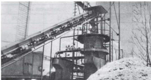
Рис. 20 Общий вид электрической станции тепловой мощностью 600 кВт, работающей на растительной биомассе, г. Санкт-Петербург [17]
