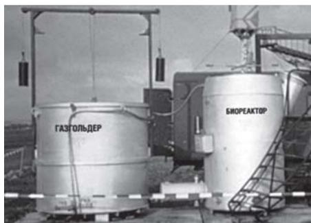
**Рис. 10.** Внешний вид биогазовой установки ИБГУ-1
