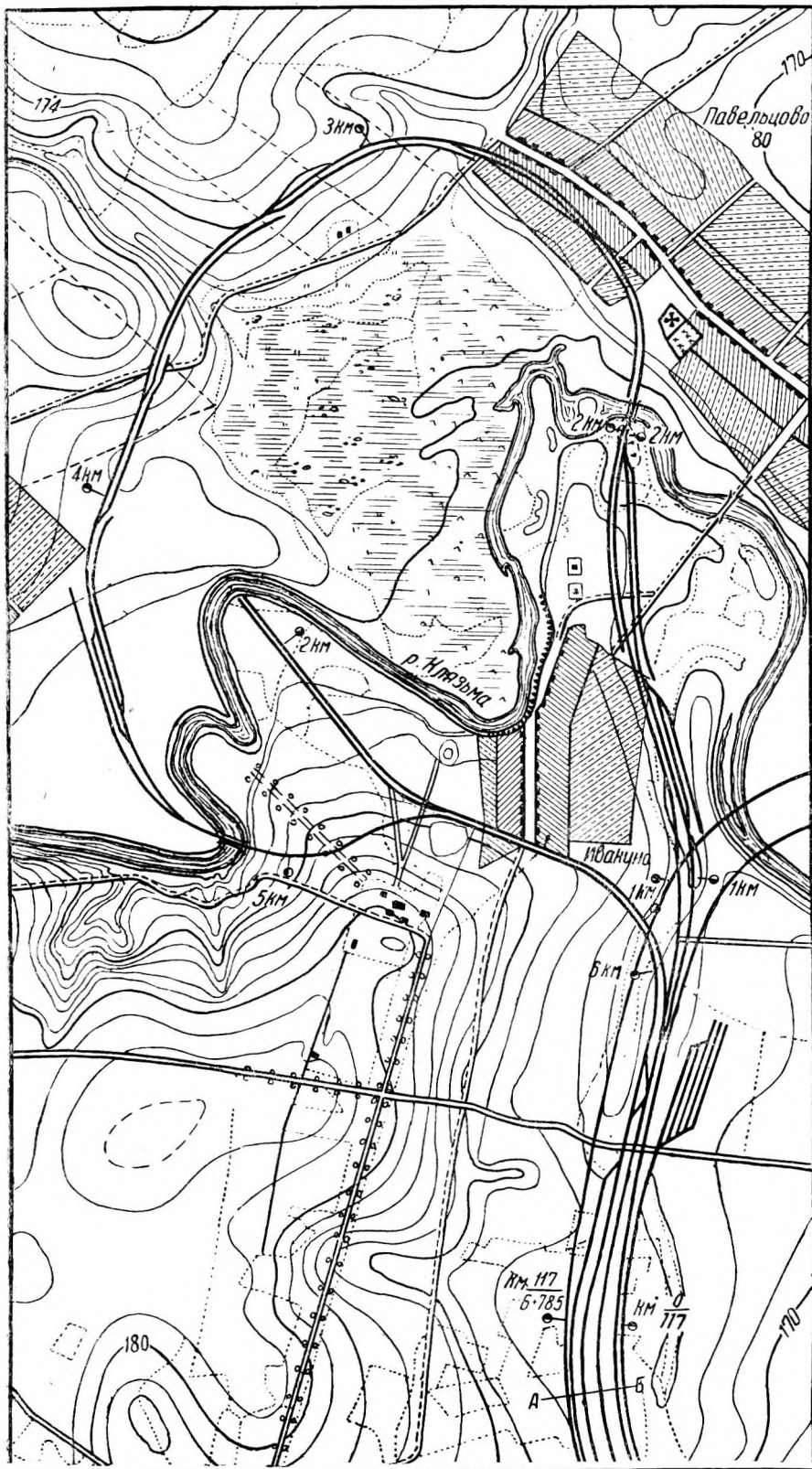
Фиг. 17. Вариант кольцевой схемы развозки грунта.
