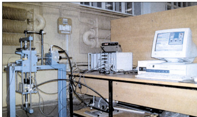
Рис. 2. Установка многоплоскостного сдвига (фирма “Wykeham Farrance”)
