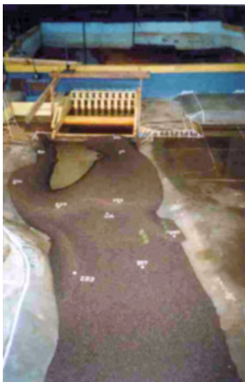
Рис. 1. Общий вид деформации русла нижнего бьефа на пространственной модели Усть-Среднеканской ГЭС (масштаб 1:120)
