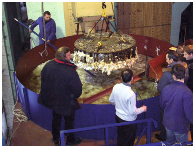
Рис. 5. Исследование фильтрующего устройства защиты труб пассивного залива
