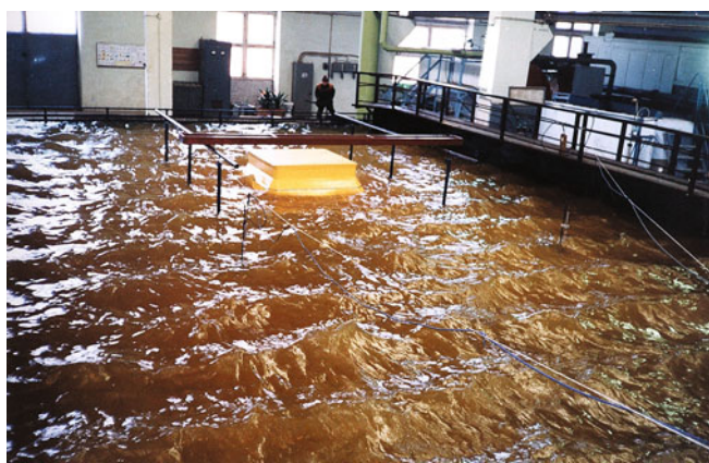
Рис. 2. Модельная площадка ОАО “ВНИИГ им. Б. Е. Веденеева” при исследованиях защиты от размывов вблизи платформы “Приразломная”
