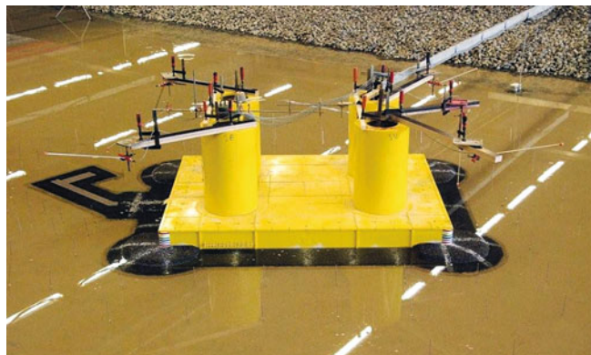
Рис. 3. Модель платформы “Арктун-Даги” (масштаб 1:60) с защитой от размывов
