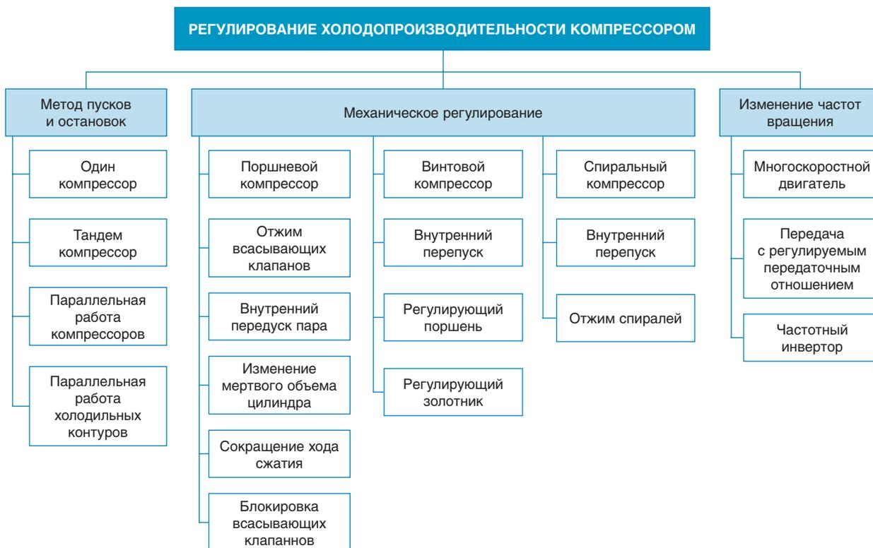
Рис. 1. Сводная таблица методов регулирования холодопроизводительности компрессоров
