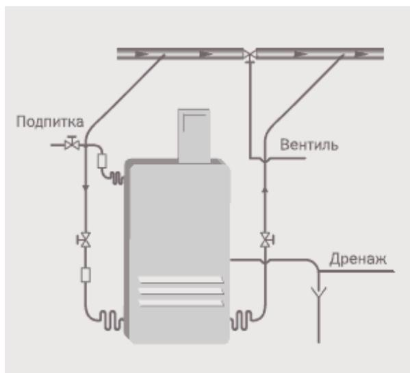
**Рис. 8. Типичная схема подключения вакуумного деаэратора**
