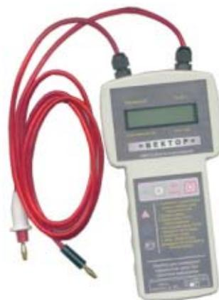
**Фото 1. Прибор «Вектор» для измерения параметров однофазной электрической цепи в режиме короткого замыкания**
