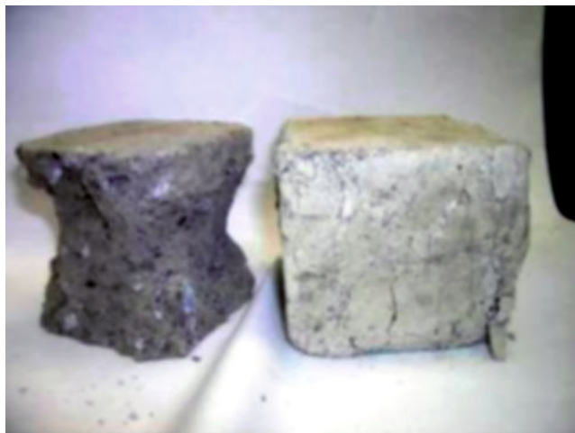
Рис. 3. Характер разрушения образцов КМ без фибры (слева) — хрупкое разрушение и с фиброй (справа) — пластическая деформация
