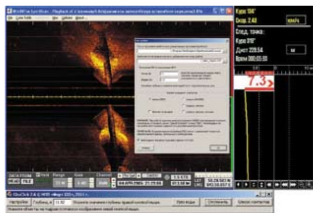
Рис. 4. Работа утилиты GBO_Click для регистрации координат гидроакустических контактов и оцифровки береговой линии
