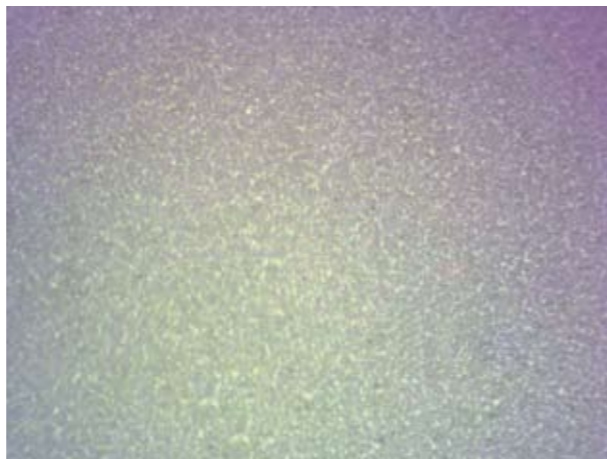
Фото пробы турбинного масла при 100-кратном увеличении после очистки
