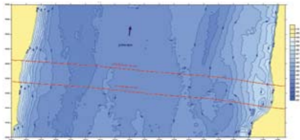
Рис. 13. Акватория до начала ПТР по засыпке трубопроводов
