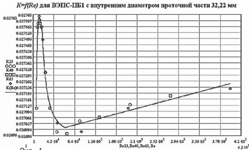
Рис. 1. Температура воды: \circ - 23 °С; \square - 40 °С; \diamond - 63 °С; сплошная линия – аппроксимирующая кривая
