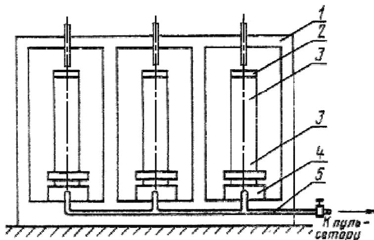
1 - рама машины; 2 - верхняя винтовая опора с оголовником; 3 - образец;
