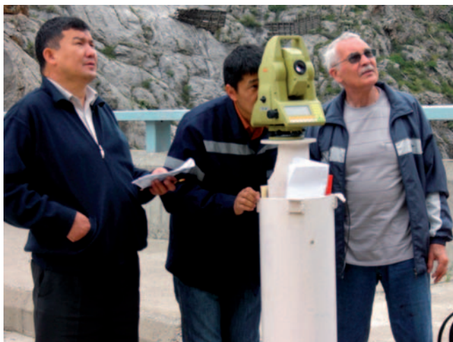
Рис. 4. Инструментальная привязка геодезистами трещин и скальных блоков массива № 59-1
