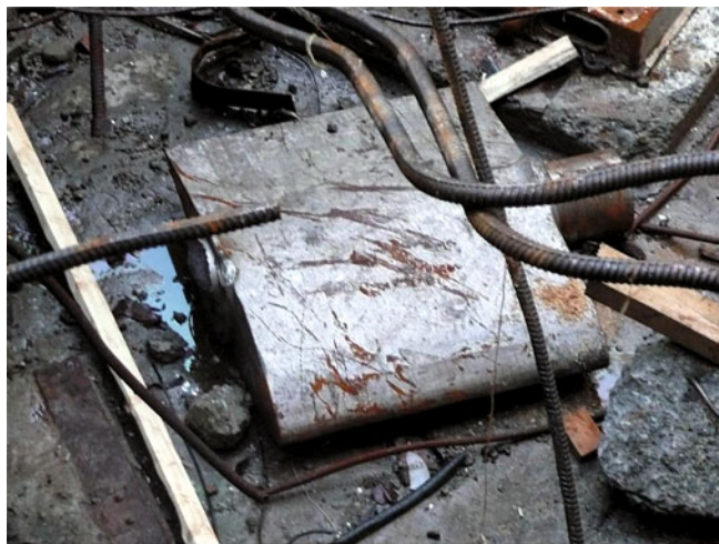
Рис. 2. Разрушенная лопатка направляющего аппарата
