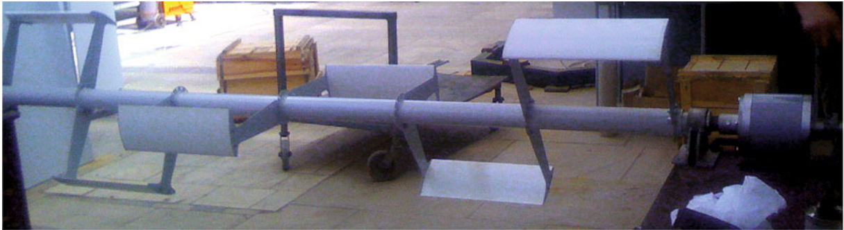
Рис. 2. Шестиярусная сбалансированная турбина с одной лопастью в каждом ярусе
