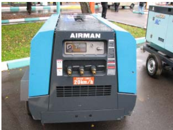
Фото 2. Пульт управления современным компрессором
