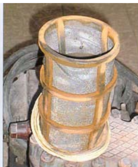
Рис. 3. Состояние сетчатого фильтра. через месяц после установки прибора
