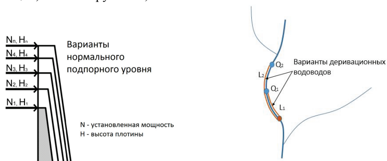
Рис. 5. Варианты нормального подпорного уровня (для плотинных МГЭС) и варианты деривационных водоводов (для деривационных МГЭС), рассматриваемые в каждом створе
