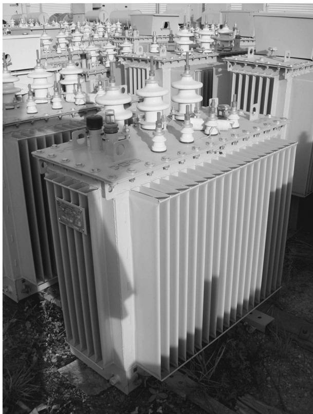
Рис. 1. Трансформатор ТМГ
