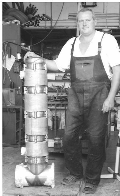
Рис. 2. Составной корпус аппарата с разъемами между секциями в местах расположения перегородок
