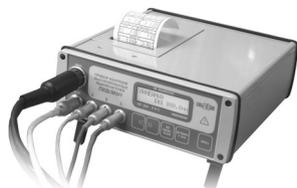
Рис. 1. Прибор контроля высоковольтных выключателей ПКВ/М6Н
