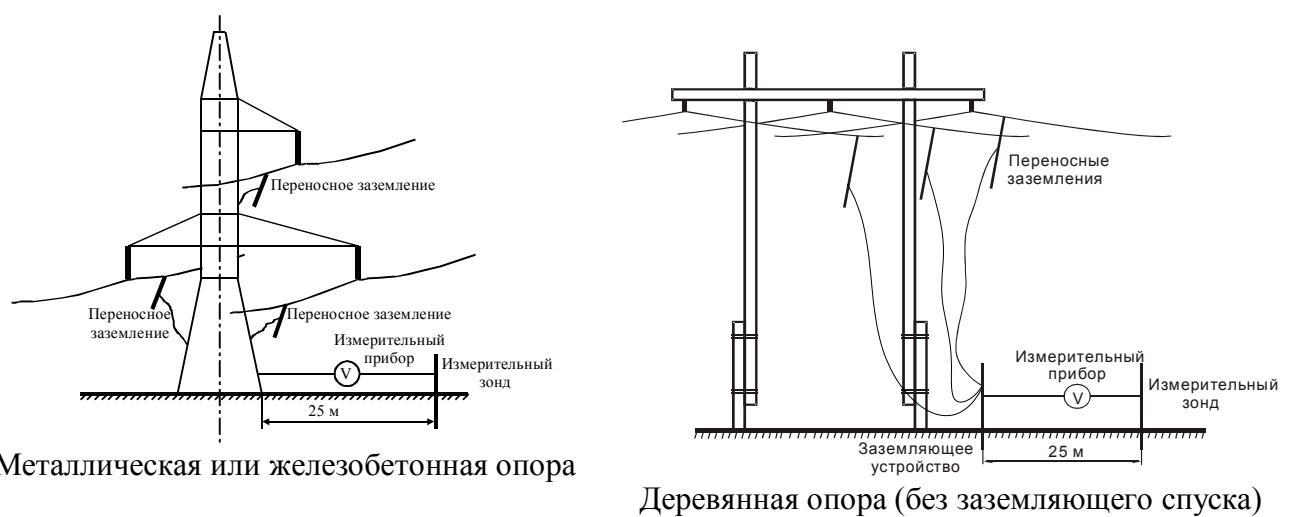
Рисунок 7 - Схемы измерений наведенного напряжения и установки заземлений на рабочем месте
