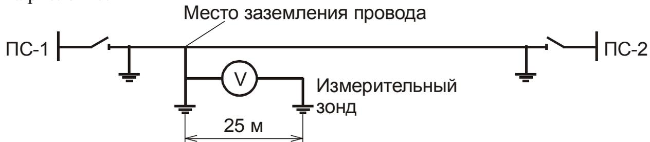
Рисунок 6 - Принципиальная схема измерения наведенного напряжения
