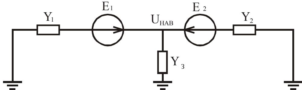
Рисунок 1 - Схема замещения для расчета значения наведенного напряжения на отключенной ВЛ
