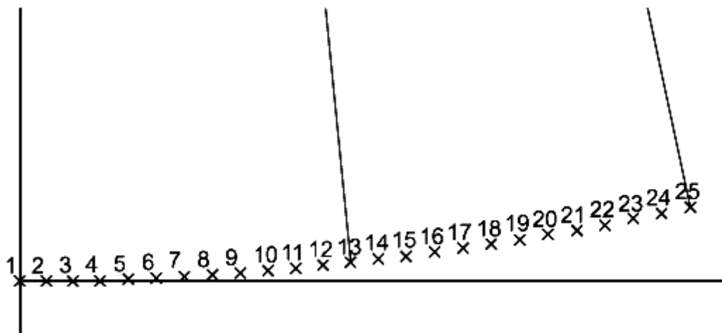
Рисунок К.7 - Укрупненная деталь рисунка К.6 для первых 25 точек перемещения центра величины при кренах плавающего объекта от 0° до 12° с шагом 0,5°
