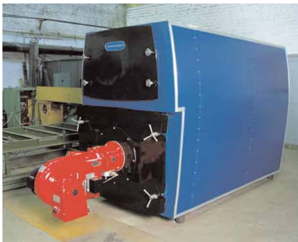
Водогрейный водотрубный котел серии «СМОЛЕНСК»
