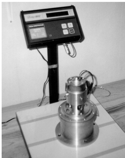
Рис.5 Устройство в сборе, тест на весах.
