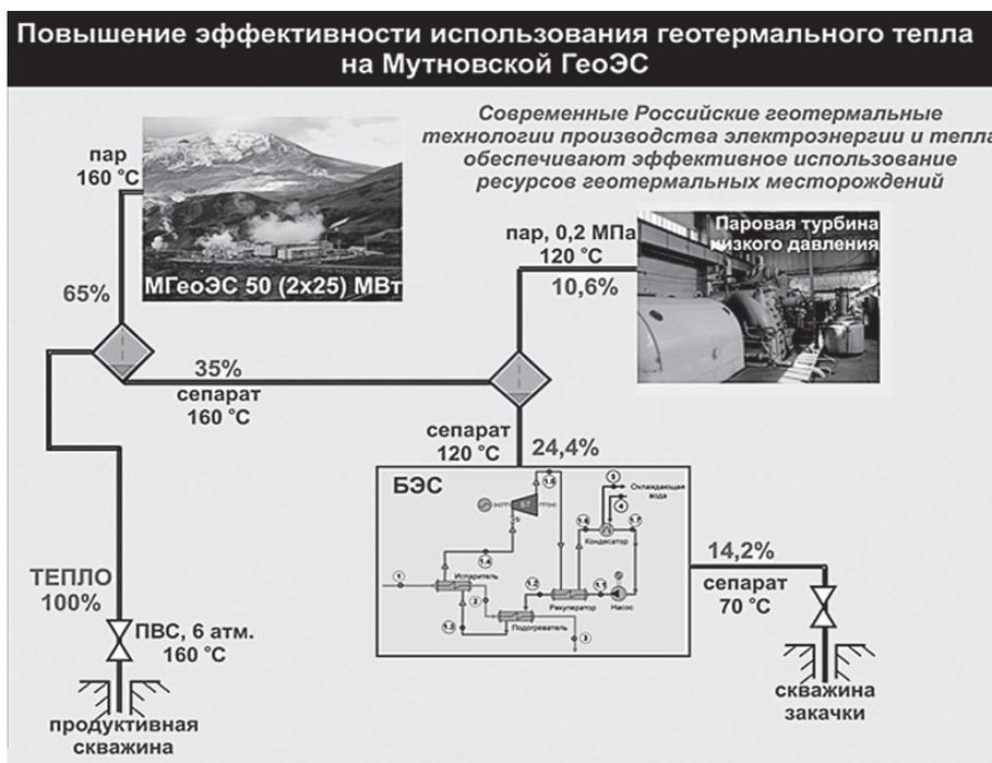
**Рис. 6.** Принципиальная схема использования БЭС и паровой турбины для утилизации сбросного сепарата Мутновской ГеоЭС
