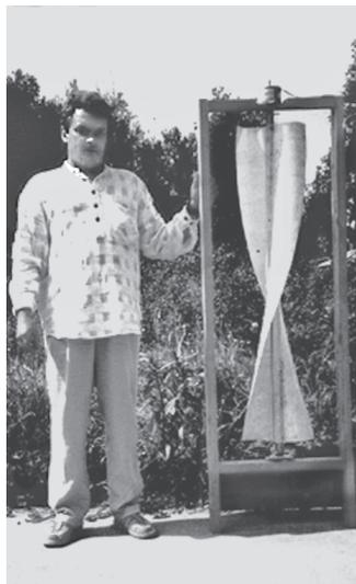
Рис. 1. Первая вертикально-осевая установка ООО «ГРЦ Вертикаль». Ротор Савониуса
