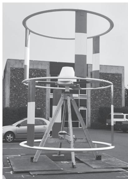
Рис 4. Вертикально-осевая установка ГРЦ-Вертикаль
