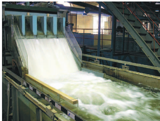
Рис. 2. Экспериментальная модель водосброса № 2 Богучанской ГЭС со ступенчатой водосливной гранью при пропуске расчетного режима (УВБ = 208,00 мм; УНБ = 141,45 м)
