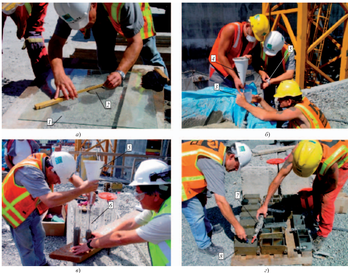
Рис. 3. Испытания цементационного раствора:
