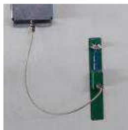
Рис. Б.2 Датчик электромагнитного типа ТМР-2. Предназначен для оперативных измерений по всем видам оборудования.
