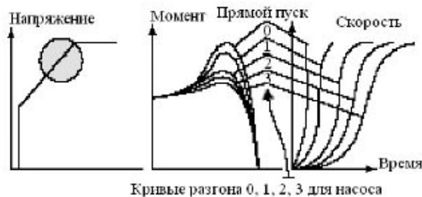
**Рис. 8. Кривые пуска, реализуемые устройством RVS-DN**
