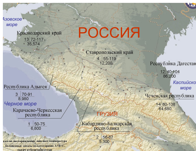
Рис. 6. Геотермальные месторождения Северного Кавказа
