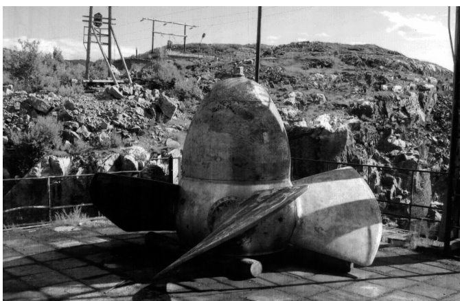
Рис. 4. Рабочее колесо французского капсульного гидроагрегата диаметром 3,3 м, проработавшего на Кислогубской ПЭС 37 лет
