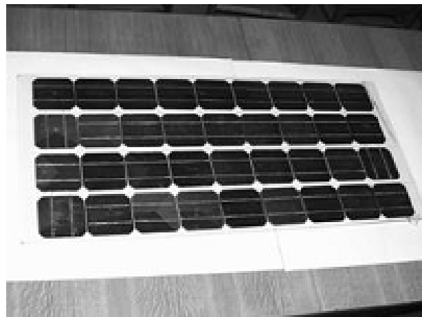
Рис. 6. Солнечный фотоэлектрический модуль, изготовленный по технологии бесполимерной герметизации. Размеры 450 x 970 мм. Электрическая мощность 50 Вт, напряжение 12 В
