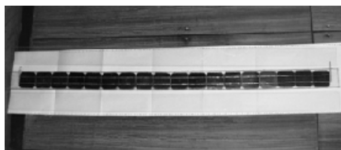
Рис. 7. Солнечный двусторонний фотоэлектрический приемник для стационарного концентратора. Размеры 2 м x 0,12 м. Ожидаемый срок службы 40 лет
