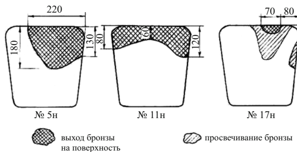
Рис. 4. Формуляр поврежденных сегментов подпятника агрегата № 6 Нижегородской ГЭС
