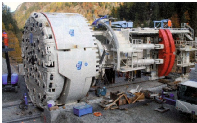
Рис. 2. Сборка проходческого бурового комплекса ТВМ диаметром 9,4 м для твердых скальных пород
