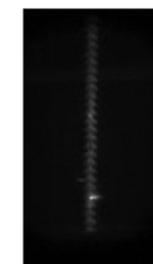
Рис. 7. Изолятор ЛК70/220, образец 1. Область локального нагрева на расстоянии 40 см от оконцевателя, избыточная температура – 8–9°C, коронные разряды на изоляторе стабильны
