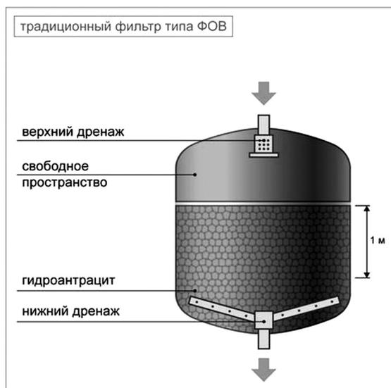
Рис. 1. Конструкция механических фильтров
