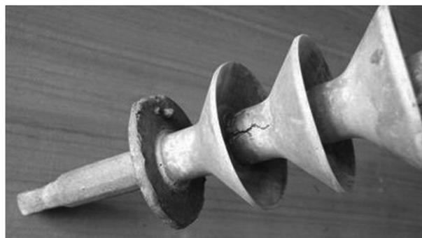
Рис. 1. Трек, эрозия защитной оболочки изолятора
