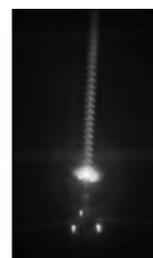
Рис. 4. Изолятор ЛК70/220, образец 3. Область повышенного нагрева 10–15 см вблизи оконцевателя, избыточная температура – 2°C, коронные разряды на изоляторе отсутствуют
