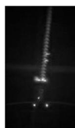
Рис. 6. Изолятор ЛК70/220, образец 2. Область повышенного нагрева 40–50 см вблизи оконцевателя, избыточная температура – 4–8°C, коронные разряды на изоляторе не стабильны
