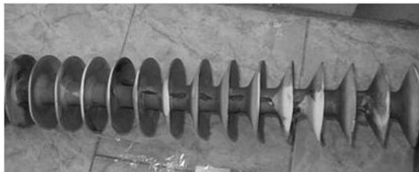
Рис. 2. Образование дендритов, треков на границе раздела, внутренняя эрозия защитной оболочки
