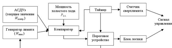
Рис. 3. Структура системы управления режимами электропотребления
