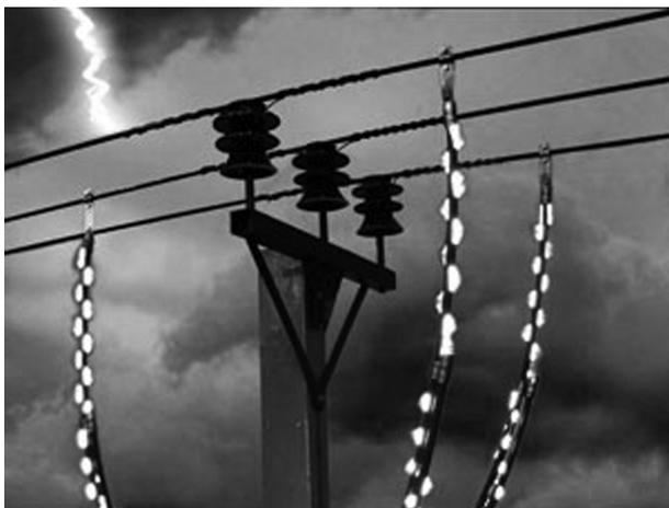
Рис. 1. РДИМ-10-1,5 на промежуточных опорах; фото испытаний
