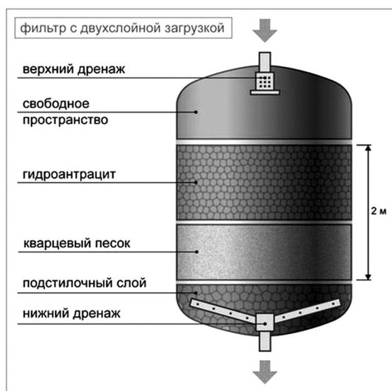
Рис. 2. Конструкция блока осветления воды
